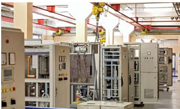
Фото 3. Сборочный цех систем возбуждения и систем управления возбуждением синхронных генераторов
